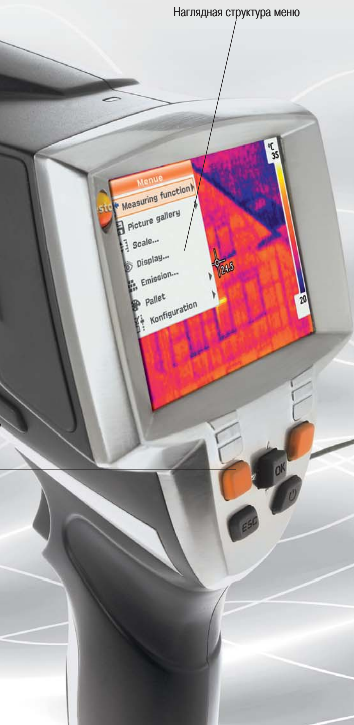
Отображение распределения поверхностной влажности для обнаружения мест с повышенным риском роста плесневого грибка
